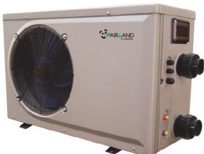
**Inversione ciclo di sbrinamento:** permette alla pompa di calore di funzionare bene anche a temperature aria molto basse (fino a 0 ° C). L'inversione di ciclo permette di sciogliere il ghiaccio che si può depositare sull'evaporatore, in modo più rapido ed efficiente rispetto ad altri sistemi di sbrinamento.
