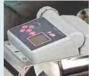
Centralina di programmazione IP 68
