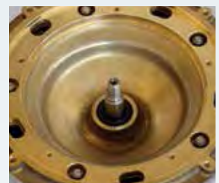
Supporto motore ottone per 1,5 HP
