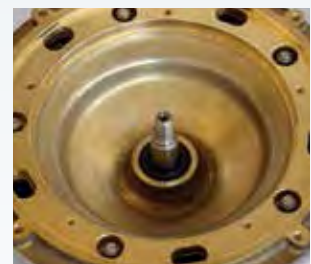
Supporto motore ottone per versioni 2,0 HP
