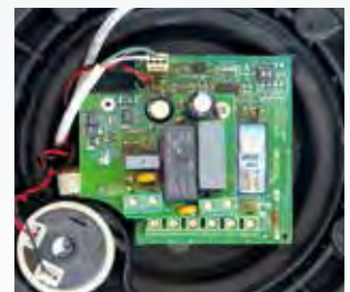
Controllo elettronico Soft-Start
